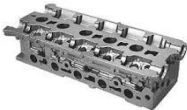
sont toujours étroitement liées à l'évolution des moteurs et, plus particulièrement déterminée par le type de distribution et, par la forme de la chambre de combustion. Pour être complet, certains (rares) moteurs n'ont pas de culasse, comme les moteurs à pistons opposés
