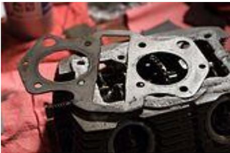
contraintes thermiques, mécaniques et chimiques très importantes, si bien qu'il reste l'une des pièces — si ce n'est la pièce — la plus fragile d'un moteur moderne
